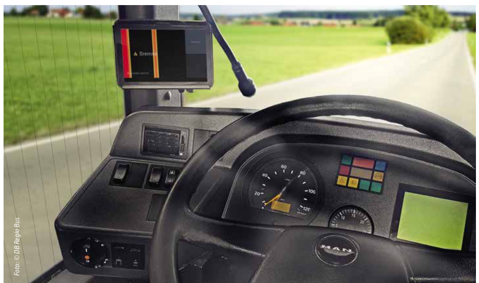
Die Instrumente im Fahrzeug geben detailliert Auskunft über CO 2 -Ausstoß, Beschleunigungs- und Bremsverhalten.
